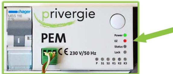
PEM kurz aus und erneut einschalten, die Kommunikationsverbindung sollte nun automatisch funktionieren und die rote LED 'EZ' sollte nicht mehr leuchten. Das Pairing zwischen PEC und PEM ist damit erfolgreich abgeschlossen.
